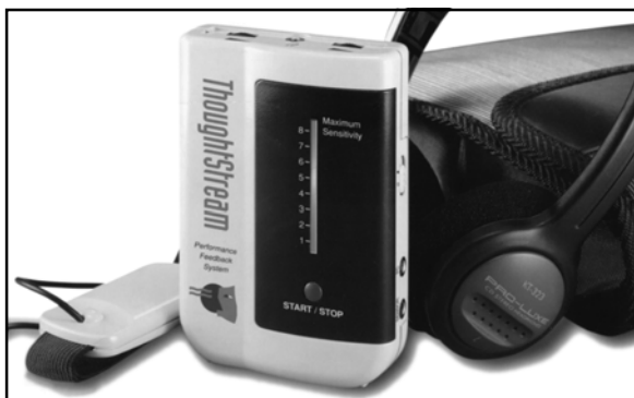
ThoughtStream II. - jeden ze dvou nejnovějších digitálních přístrojů ke kontrole vědomí na principu biofeedback s měřením elektrického odporu pokožky.
