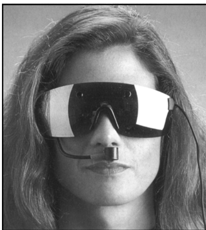
Breathwork Explorer - přístroj, který je kombinací dvou metod - AVS a biofeedback. Stimulační brýle jsou opatřeny dechovým senzorem.
